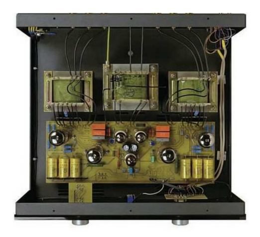
Sous le capot de protection, on découvre une carte unique de dimension moyenne destinée à relier les composants électroniques entre eux. Le module d'entrée fait appel à 3 doubles triodes : 1 ECC83S JJ Electronic pour l'étage d'entrée et 2 x ECC83S JJ Electronic pour l'étage driver.
